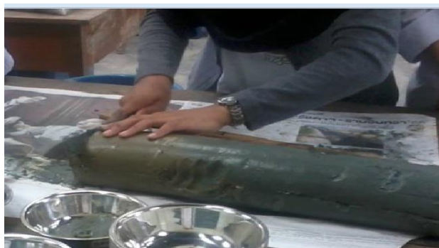
ภาพที่ 3.4 การตัดแบ่งตัวอย่างตะกอนดินเป็นชั้นๆ หนาชั้นละ 1 เซนติเมตร
