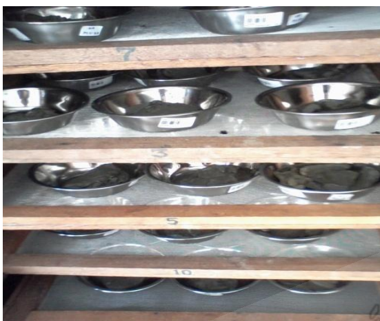
ภาพที่ 3.5 การอบไล่ความชื้นของตัวอย่างตะกอนดิน
