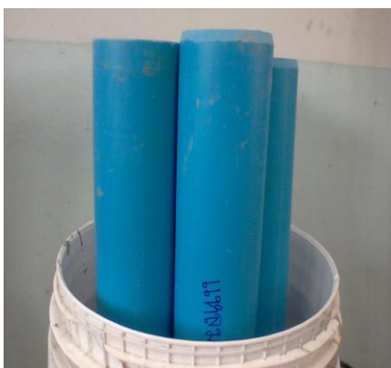
ภาพที่ 3.2 ท่อพีวีซีสำหรับเก็บตัวอย่างตะกอนดิน
