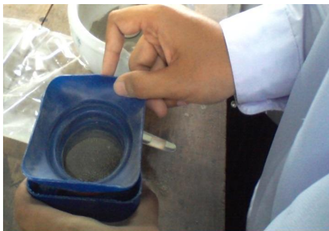
ภาพที่ 3.8 การร่อนตัวอย่างตะกอนดินให้เป็นเนื้อเดียวกัน
