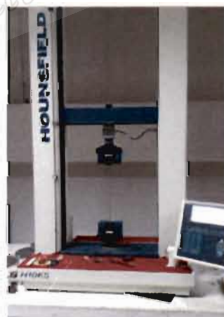
ภาพที่ 3.8 เครื่องทดสอบสมบัติการดึง (Tensile tester)
