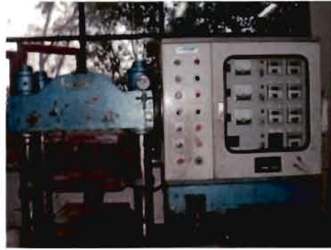
ภาพที่ 3.5 เครื่องขึ้นรูปด้วยแม่พิมพ์แบบอัด (Compression Moulding)
