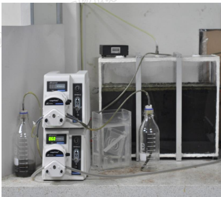
ภาพที่ 3.11 ระบบถังปฏิกรณ์ PFR สำหรับผลิตมีเทน
