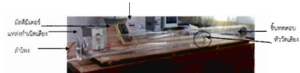
ภาพที่ 2 ชุดทดสอบสมบัติการดูดซับเสียงที่สร้างขึ้น โดยใช้เครื่องกำเนิดเสียงรุ่น LAG-120B AUDIO GENERATOR ผลิตโดย LEADER ELECTRONICS CORP Japan [9]
