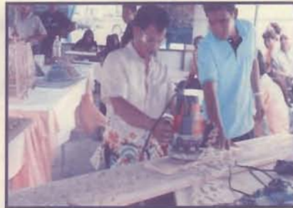
๕. ใช้เครื่องเร้าเตอร์กัดเหลี่ยมของลายฉลุไม้ให้ดูสวยงาม
