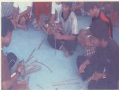
คัดเลือกไม้ไผ่แล้วนำมาเหลาให้เรียบ โดยใช้มีดหรือพร้า
