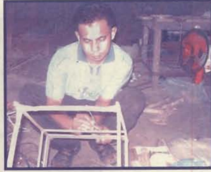
๘. นำไม้สำหรับทำไม้บนและไม้ล่างมาวัดและตัดตามขนาด นำโครงกรงที่ประกอบเสร็จแล้วไปทำร่องด้วยเร้าเตอร์
