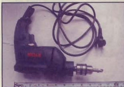
๔. เครื่องสว่าน (สำหรับเจาะไม้)
