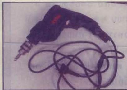
๔. เครื่องสว่าน (สำหรับเจาะไม้)
