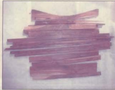
๒. นำไม้ที่ได้มากบไส เพื่อให้ไม้มีพื้นผิวเรียบเสมอกัน
